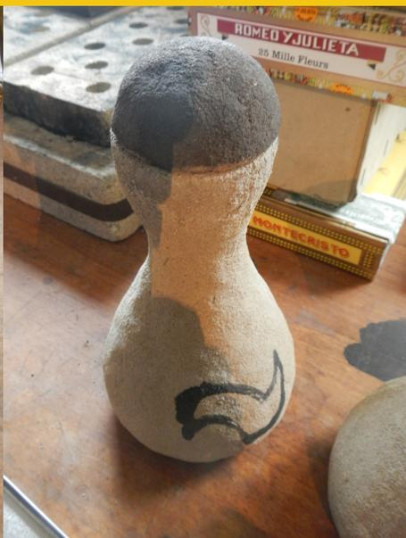
La quantità di metallo necessaria per la fusione, calcolata sulla base dei pesi specifici della cera e del metallo, viene poi pesata e introdotta nel crogiolo a pezzettini o sotto forma di filo spezzato. Utilizzando l'apposito tappo si provvede a chiudere lo stampo, che con un'ultima operazione viene ricoperto con la stessa miscela di argilla utilizzata per il mantello di rinforzo.
