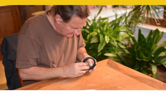
Der Kern wird nun vollständig mit dünnen Wachsplatten überzogen. Anschliessend werden Wachsdrähte angelötet und zentral zu einem einzigen, etwas dickeren Wachsdraht zusammengeführt.
